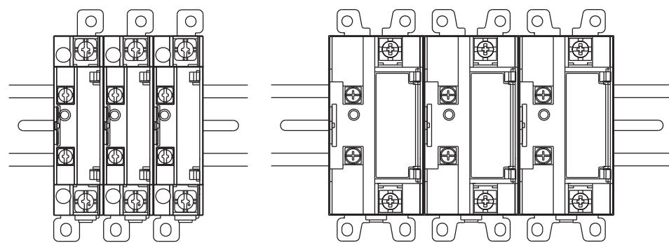
※ 3台密着取付けの場合、負荷電流定格を20%以上低減して御使用ください。
